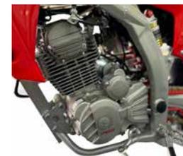
Monocilíndrico, 4 tiempos, SOHC, descompresor automático, cigüeñal liviano
