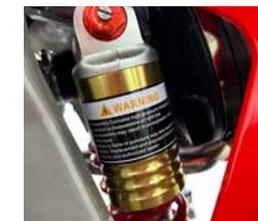
Amortiguador monoshock 480 mm con pistón de 40 mm de diámetro. Regulable en rebote, compresión y precarga
