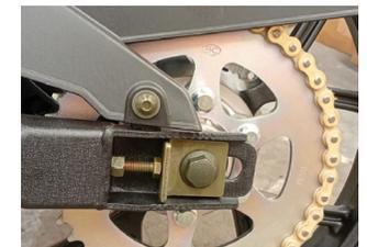
Cadena de transmisión paso 520 con O´ring
